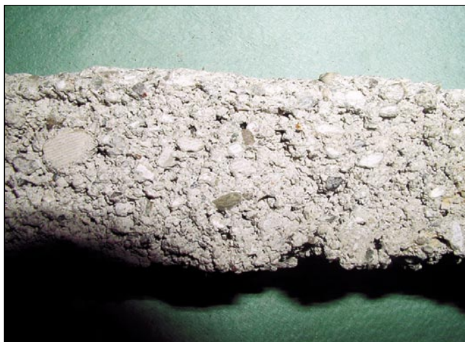
Struktura estriha, mikroarmiranega s polipropilenskimi vlakni
