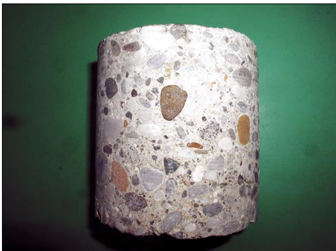
Struktura normalnega betona plošče industrijskega tlaka
