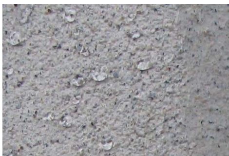
Slika Silifob 4: Plinobeton, zaščiten s Silifobom, silikonsko vodoodbojno impregnacijo: viden kapljičast, vodoodbojen učinek
